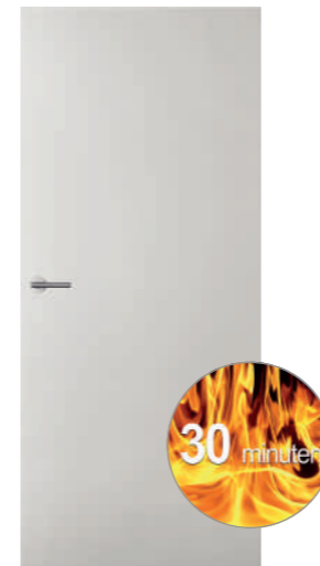
VLAK Boarddeur 30 min. brandwerend ■ Met vlasvezelplaat kern, slotgat en opschuimende strips
